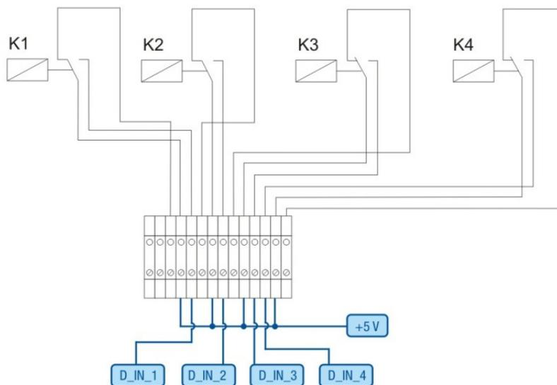
Abb.: Verkabelung Rundsteuerempfänger mit 4 Relais - Beispiel 1
