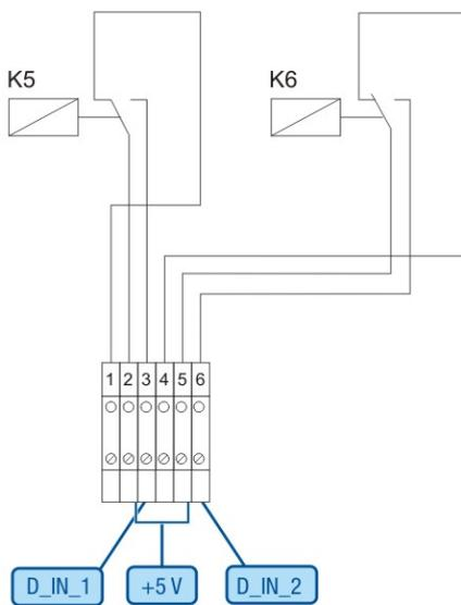
Abb.: Verkabelung Rundsteuerempfänger mit 2 Relais - Beispiel 2
