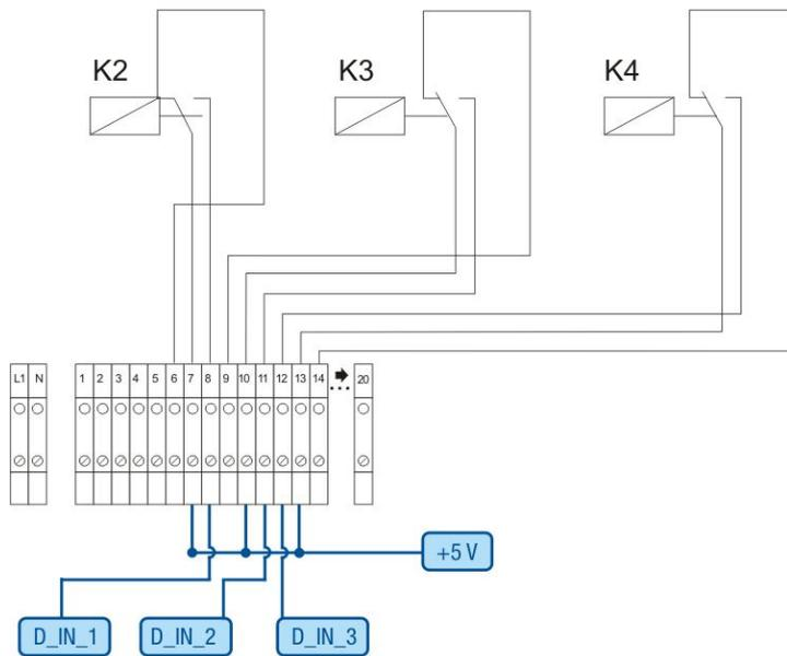
Abb.: Verkabelung Rundsteuerempfänger mit 3 Relais - Beispiel 3
